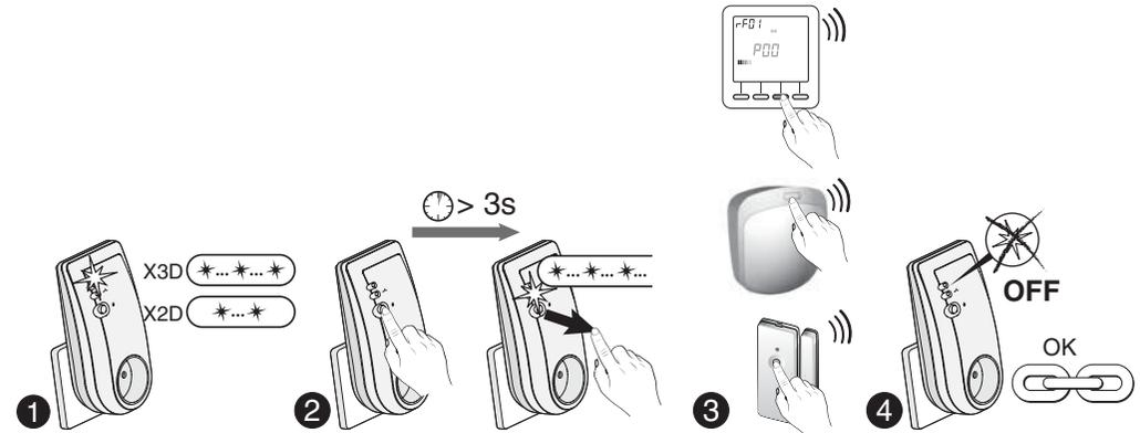
1 Bei Spannungszuschaltung (1) warten Sie bis die Kontrollleuchte 3 Mal (X3D) oder 2 Mal (X2D) blinkt.
